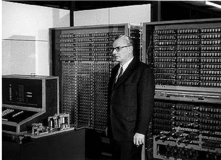
Konrad Zuse con lo Z3 ricostruito nel 1961. A sinistra la memoria, a destra l'unità aritmetica con relè a passo e la console col lettore a nastro perforato.
