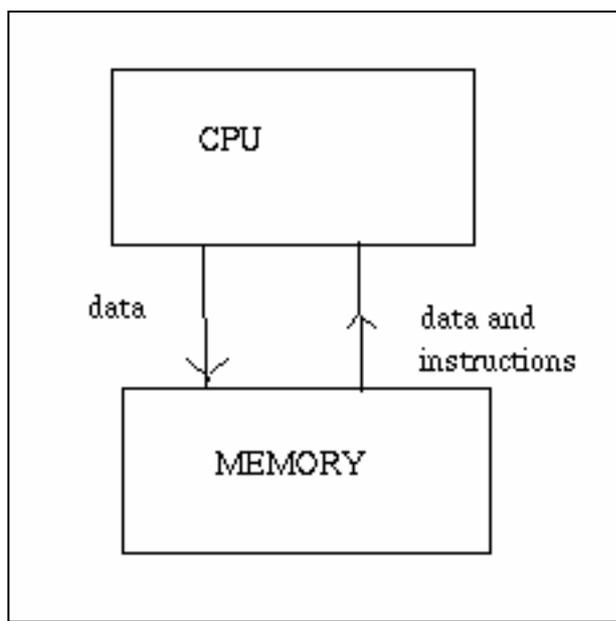
Discrete Variable Automatic Computer) completata nel 1950. I moderni computer digitali sono quasi tutti basati su un'architettura definita nel 1945 da Von Neumann nel progetto dell'elaboratore EDVAC. L'elaboratore di Von Neumann è costituito da due organi di base, il *processore* e la *memoria centrale* (vedi figura 2.2c). Le operazioni degli attuali computers possono essere modellate nell'esecuzione del ciclo seguente:
